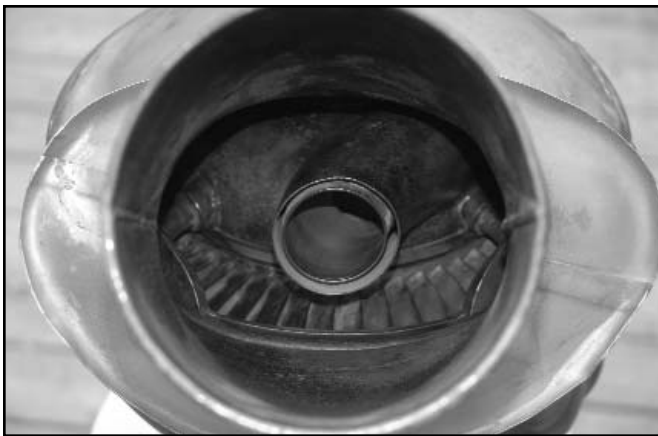
Fig. 8. Cooling Cap Air Outlet
