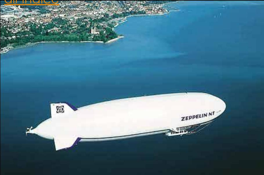
Un'altra notevole innovazione consiste nel sistema propulsivo e di manovra : i due motori principali possono ruotare di 110° e il motore di coda muove due eliche: una , fissa, consente di manovrare lateralmente il dirigibile, l'altra, che ruota su un asse orizzontale può fornire una spinta verso l'alto o verso il basso controllando il beccheggio.
