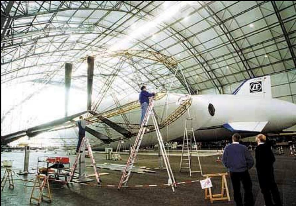
Lo scheletro in costruzione, si notano due delle tre ordinate in fibra di carbonio.
