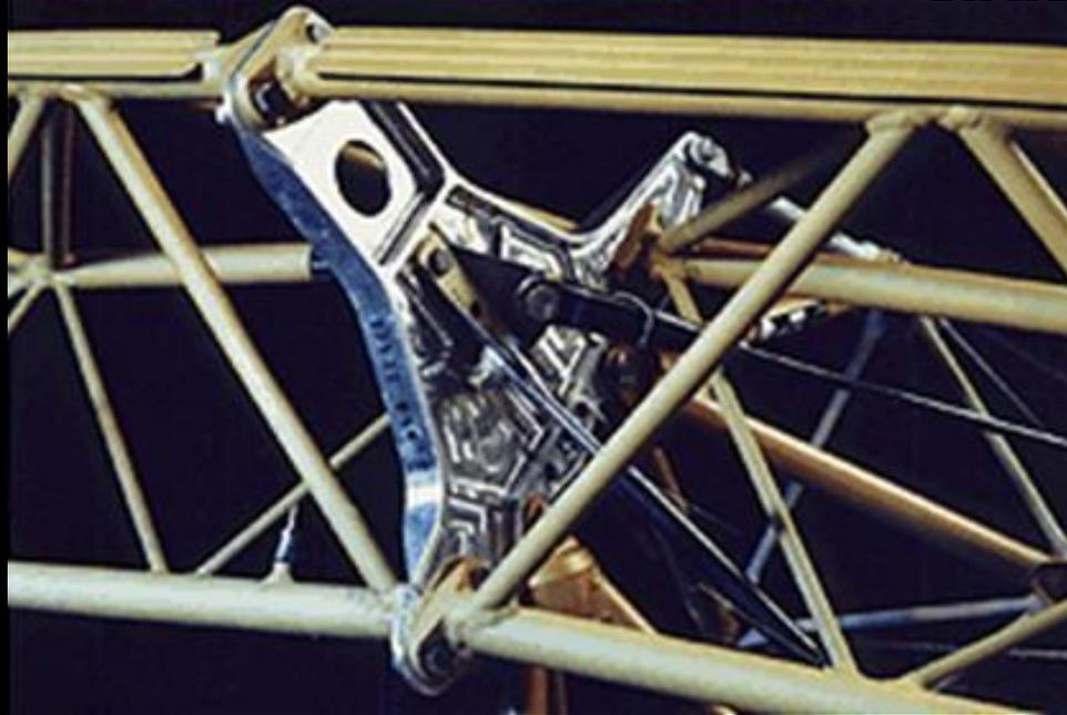
Anno 1996. Particolare di trave dell' NT N 07. Si è mantenuta la struttura triangolare, adottando per le travature di parete la sezione circolare cava. Le tre ordinate principali sono in fibra di carbonio
