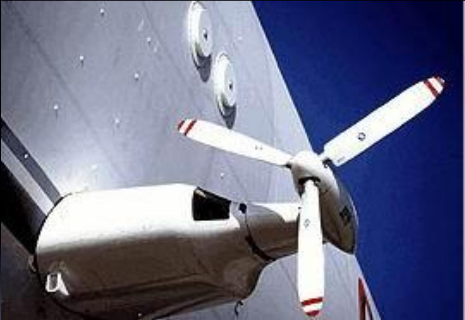
Particolare di una delle eliche laterali e dello snodo
