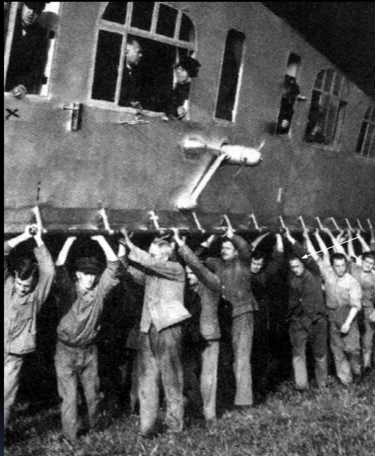
Operazioni di manovra al suolo: il generatore a elica dell'impianto radio è in posizione retratta, durante il funzionamento veniva ruotato verso il basso, disponendo l'elica perpendicolarmente al vento relativo.
