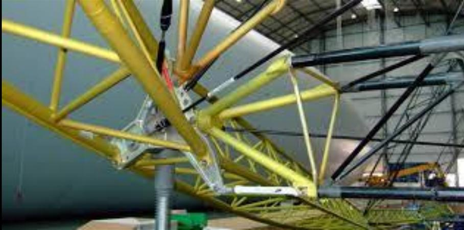
Lo scheletro in costruzione, si notano due delle tre ordinate in fibra di carbonio.
