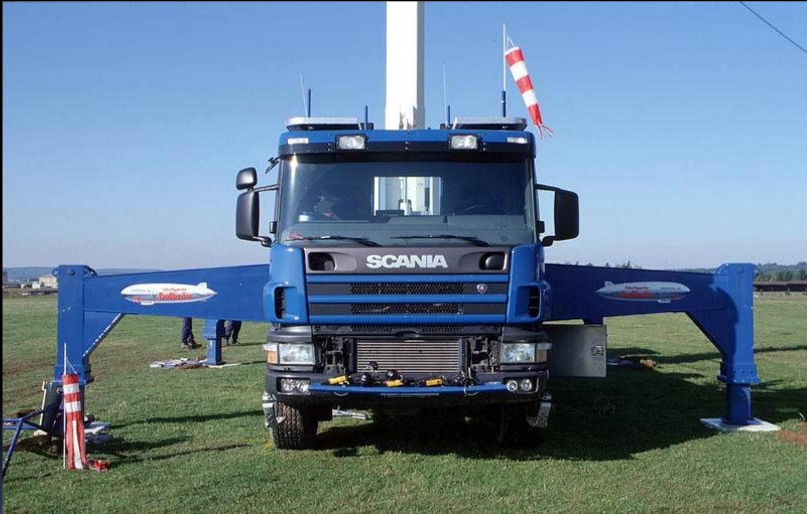
Particolare dell'autocarro con gli stabilizzatori estesi
